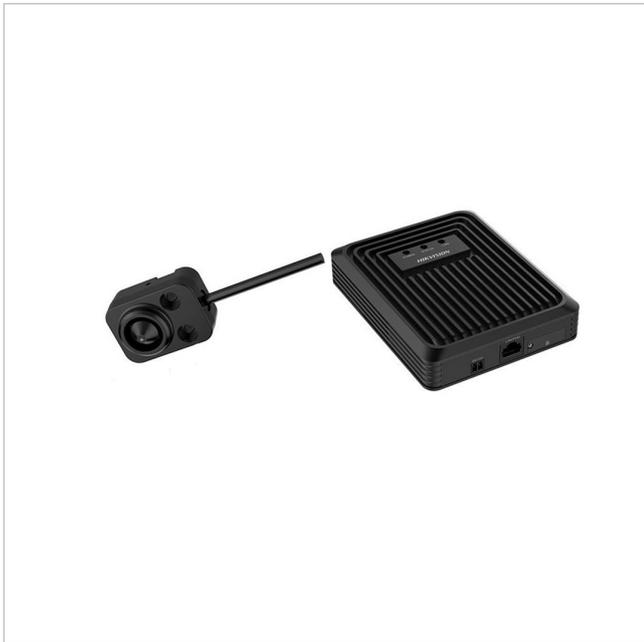
1/2.8" Netzwerk Kamera, Covert 1920x1080, H.265, 2,8mm, 2x Objektiv in L-Form, 2m Kabel
