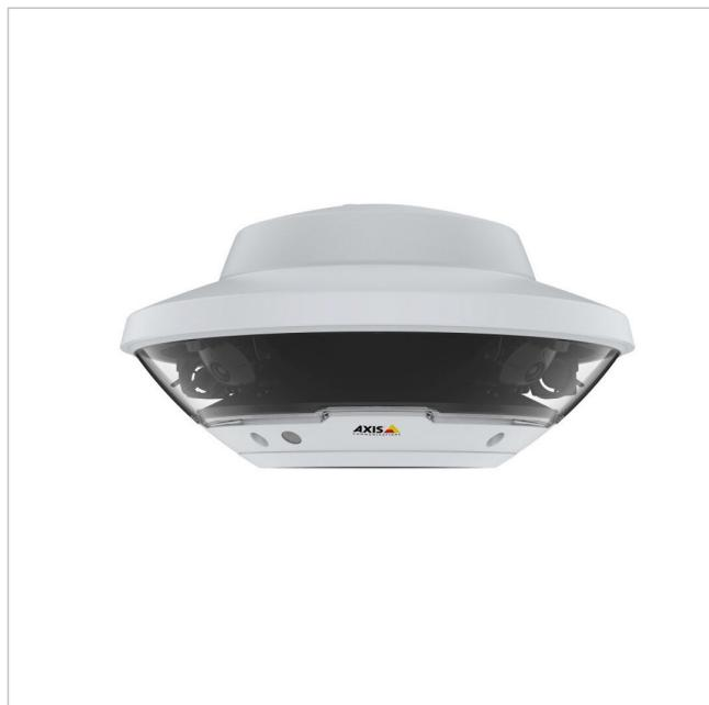
IP Multidirektional Kamera Erweiterung für AXIS Q61-E, WDR, 4x 2592x1944, IP66, IK10
