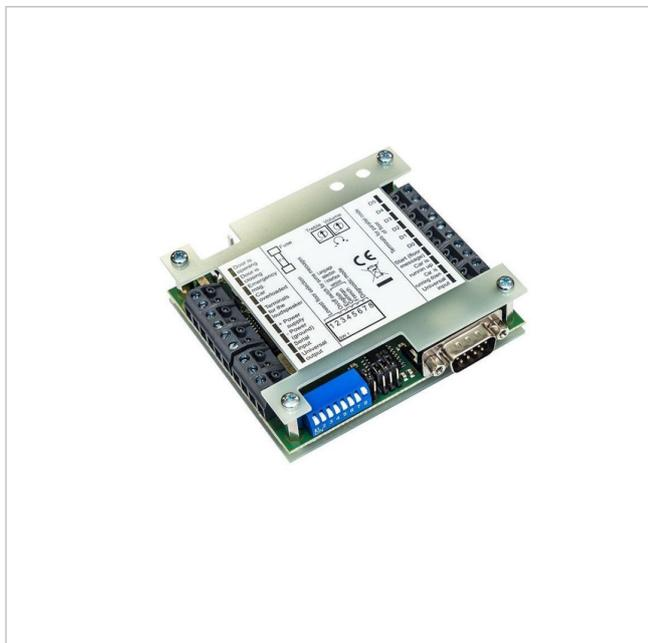
Audio Modul zur Ankündigung des Stockwerks im Fahrstuhl, für 2N Liftsysteme
