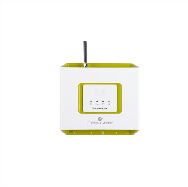
LTE Gateway, zur Anbindung von 2N Lift Systemen an Einsatzzentrale
