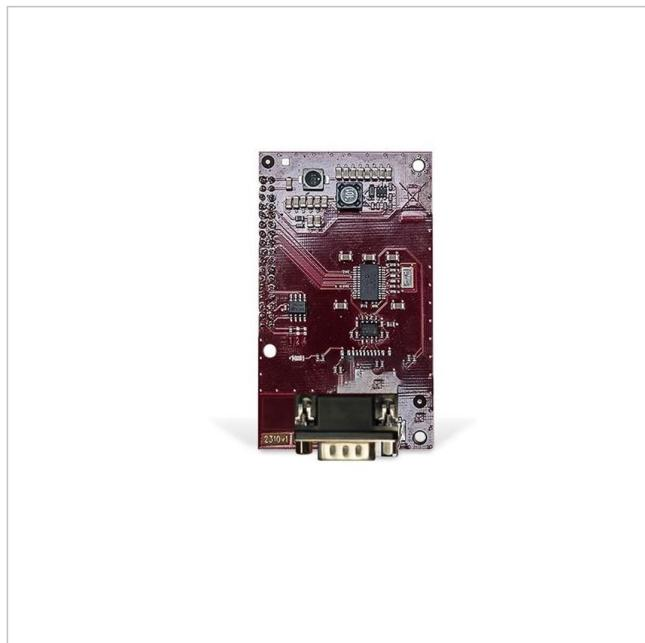
Serielle Schnittstelle Modul, für Lift8 Zentraleinheit,
