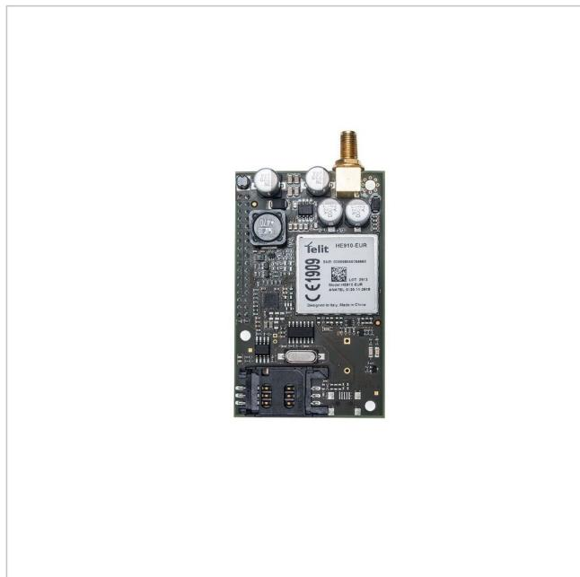
Schnittstellen Karte, UMTS, für Lift8 Zentraleinheit
