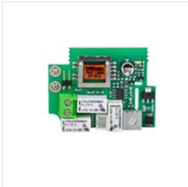
Verstärker Modul, für Lift1 Sprechstelle, einstellbare Verstärkung
