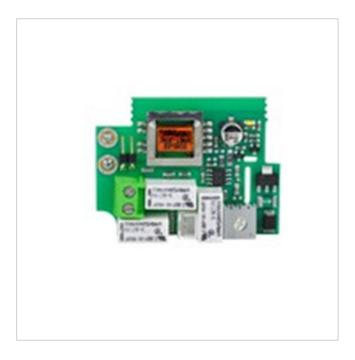
Verstärker Modul, für Lift1 Sprechstelle, einstellbare Verstärkung
