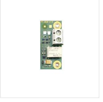
Erweiterungs Modul, für Lift1 Sprechstelle, stoppt Aufzug bei Fehler auf Telefonleitung
