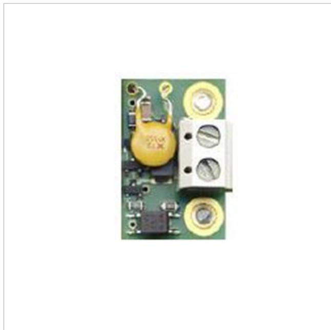
Erweiterungs Modul für Lift1 Sprechstelle , DTMF gesteuerter Schalter
