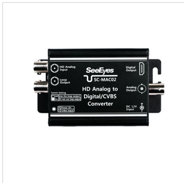
Konverter, HD Analog nach HDMI, 1x HD Analog IN, HDMI OUT, Composite OUT
