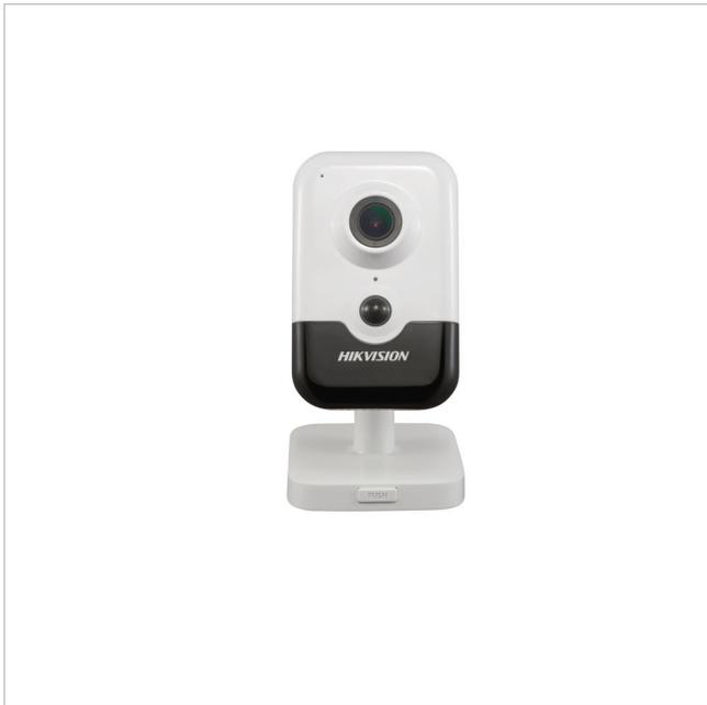
1/3" Netzwerk Cube Kamera, Tag/Nacht, 2688x1520, WDR, 2,8mm, PIR, Infrarot, Netzteil
