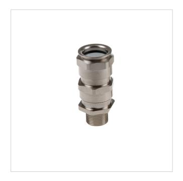
Kabelverschraubung, Ex db/eb, für armierte Kabel, M20, 13,5-21mm, Messing vernickelt
