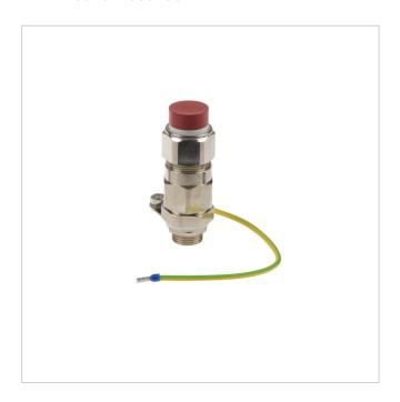
Kabelverschraubung, Ex e, für armierte Kabel, M20, 12,5 - 20,9mm, Messing vernickelt
