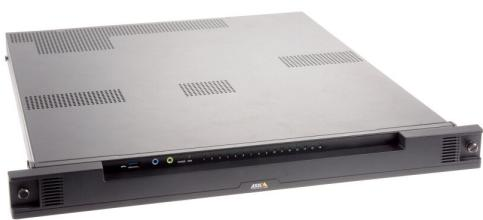
Netzwerk Video Rekorder, 16 IP Kanäle, 8 TB HDD, PoE Switch, HDMI, USB 3.0
