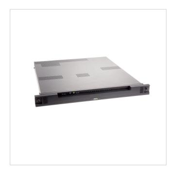
Netzwerk Video Rekorder, 16 IP Kanäle, 8 TB HDD, PoE Switch, HDMI, USB 3.0
