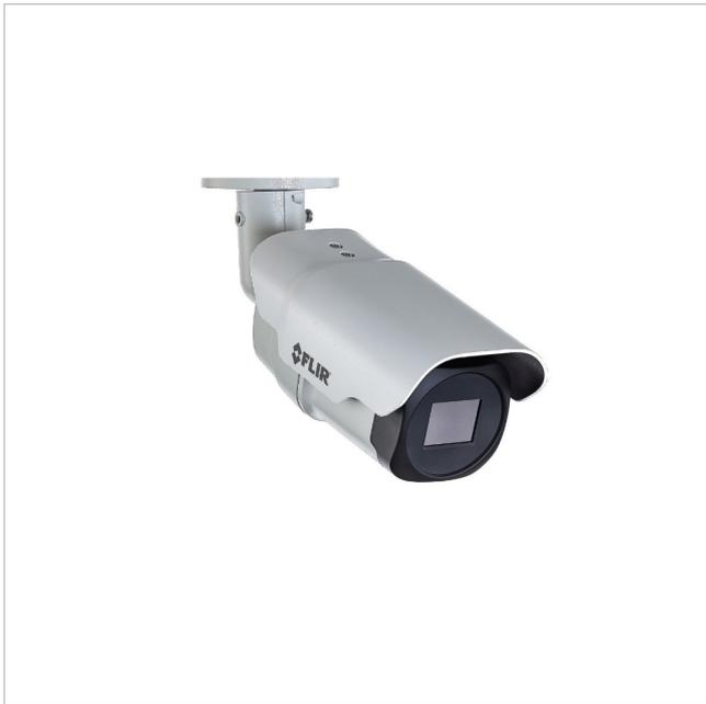
Wärmebild Netzwerk Kamera, 3,7mm, 93° FoV, 25Hz, EU, 320x240, ungekühlt
