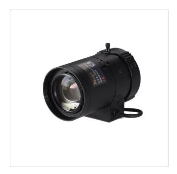
F1,6/8-50mm 5Megapixel Objektiv, für 1/2.7" Sensoren, DC-Blende, CS-Mount
