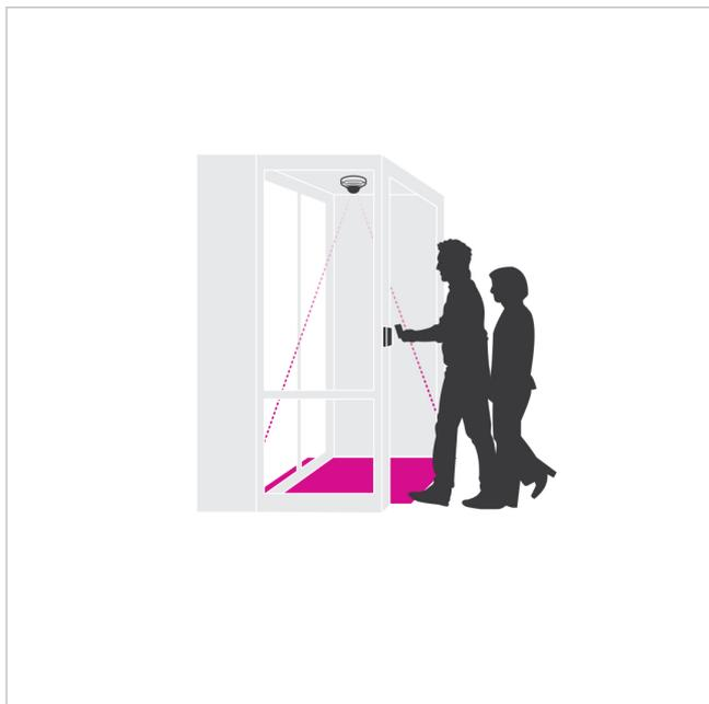
Analyse Modul, Tailgating Detector, kamerabasiert, für Axis ACAP, E-Lizenz
