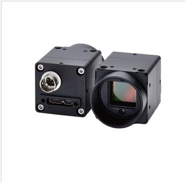
USB 3.0 Gehäusekamera, Mono, 1" 8,9 MP Sony CMOS, 42,3 fps, C-Mount
