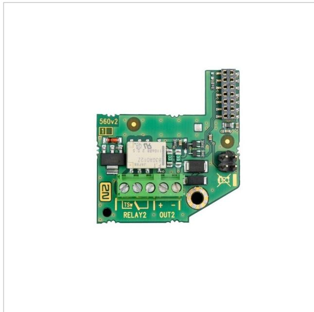
Sabotagekontakt und Schaltkontakteingang für 2N IP Force und Safety
