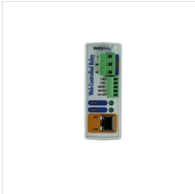
Relais, über HTTP Befehle steuerbar, 1x Ausgang, 1x Eingang
