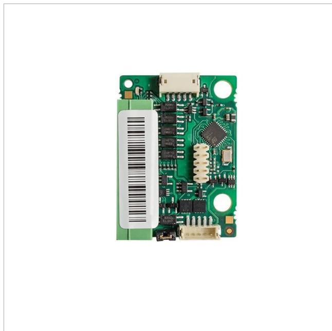
Wiegand Modul, zum Einbau in eine Verso IP Basiseinheit
