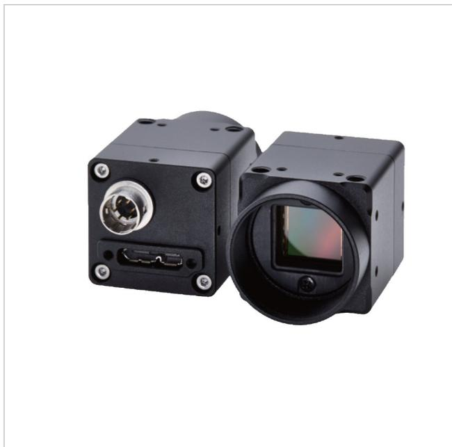
USB 3.0 Gehäusekamera, Farbe, 5 MP Sony CMOS, 2/3", 75 fps, C-Mount
