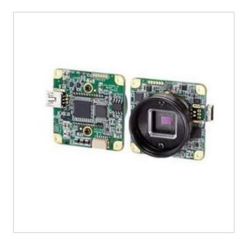
Mini-USB S/W-Platinenkamera 640x480, 1/3" uLens Mount abgewinkelter USB-Anschluss
