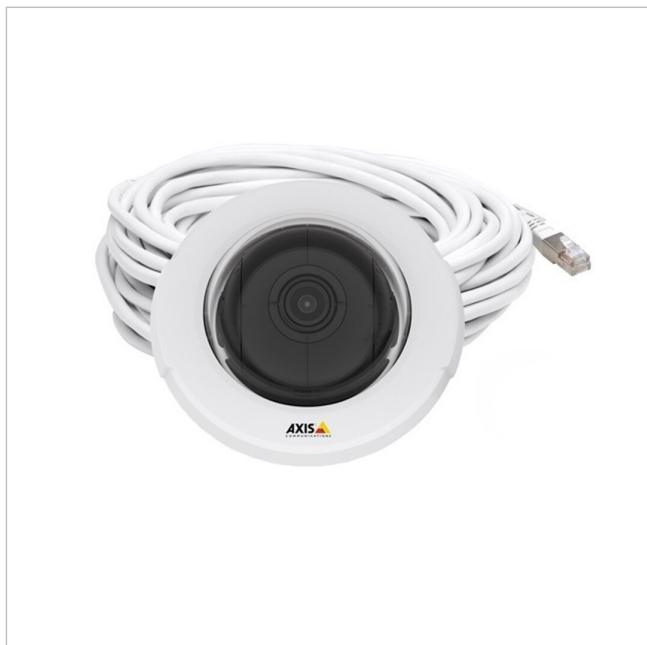
1/2,8" Dome Sensor Einheit, Einbau, 2,8mm, 1920x1200, IP66, IK09, für AXIS F41/F44
