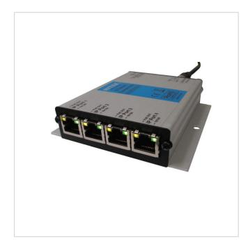
Ethernet, PoE Extender, Koax, 4 Port, Erweiterung um 500m, Transmitter
