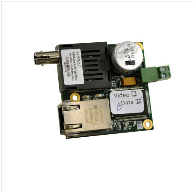
Medienkonverter, PCB, 2 Faser, MM, 100Mbps, SC Stecker
