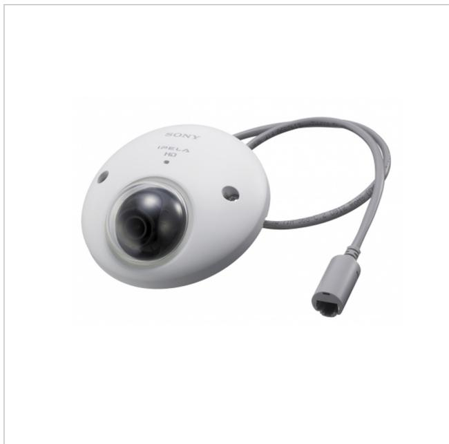
Netzwerk Dome, Fix, Außen, 1920x1080, 113° FoV, IP66, ISO16750
