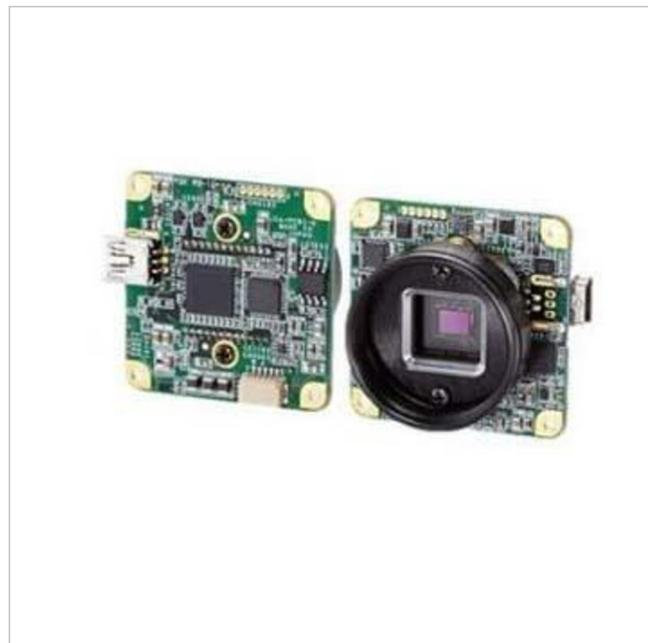
Mini-USB S/W-Platinenkamera 1280x960, 1/3" CS-Mount abgewinkelter USB-Anschluss
