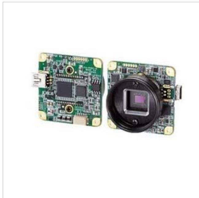
Mini-USB S/W-Platinenkamera 640x480, 1/3" CS-Mount abgewinkelter USB-Anschluss
