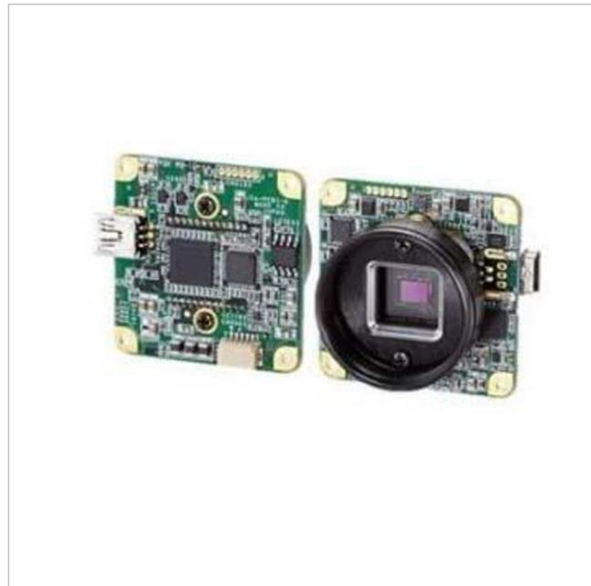
Mini-USB Farb-Platinenkamera 640x480, 1/3" CS-Mount, abgewinkelter USB-Anschluss
