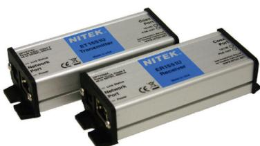
Ethernet Extender, bis zu 300m über Zweidraht, 1x 100BaseT- Port, TX/RX-Set, inkl. PS48
