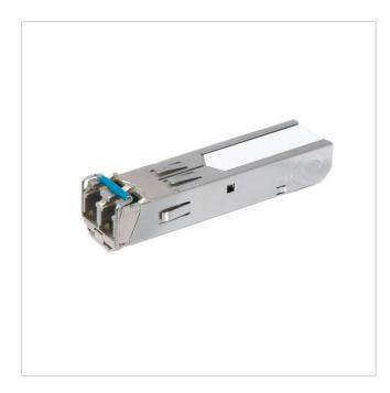
SFP Port Fast 2 Fiber Mini GBIC Modul, Single mode, 1310nm - 20km, für hohe Temp.
