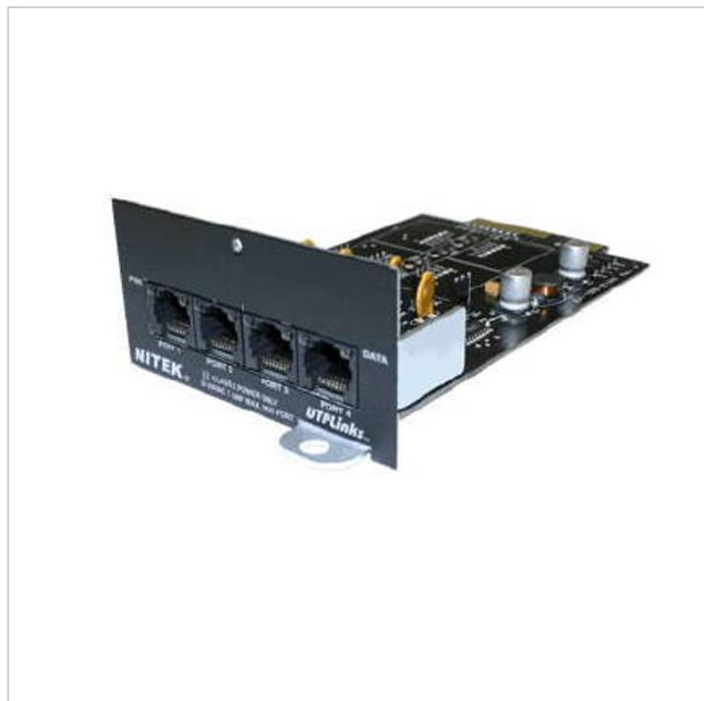
4 Kanal RS-422 und Spannungs-Übertragungskarte
