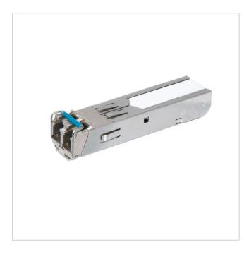
SFP Mini-GBIC Transceiver, Multi Mode, 2 Fiber, 550m, 1000Base-SX, für hohe Temp.
