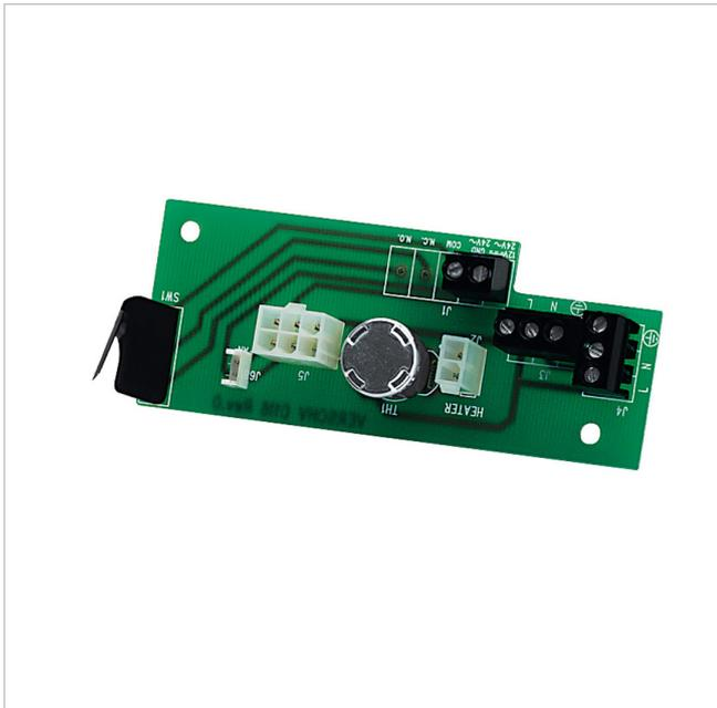
Öffnungsschutzschalter (Karte), Vandalismusschutz-Schrauben / Schlüssel
